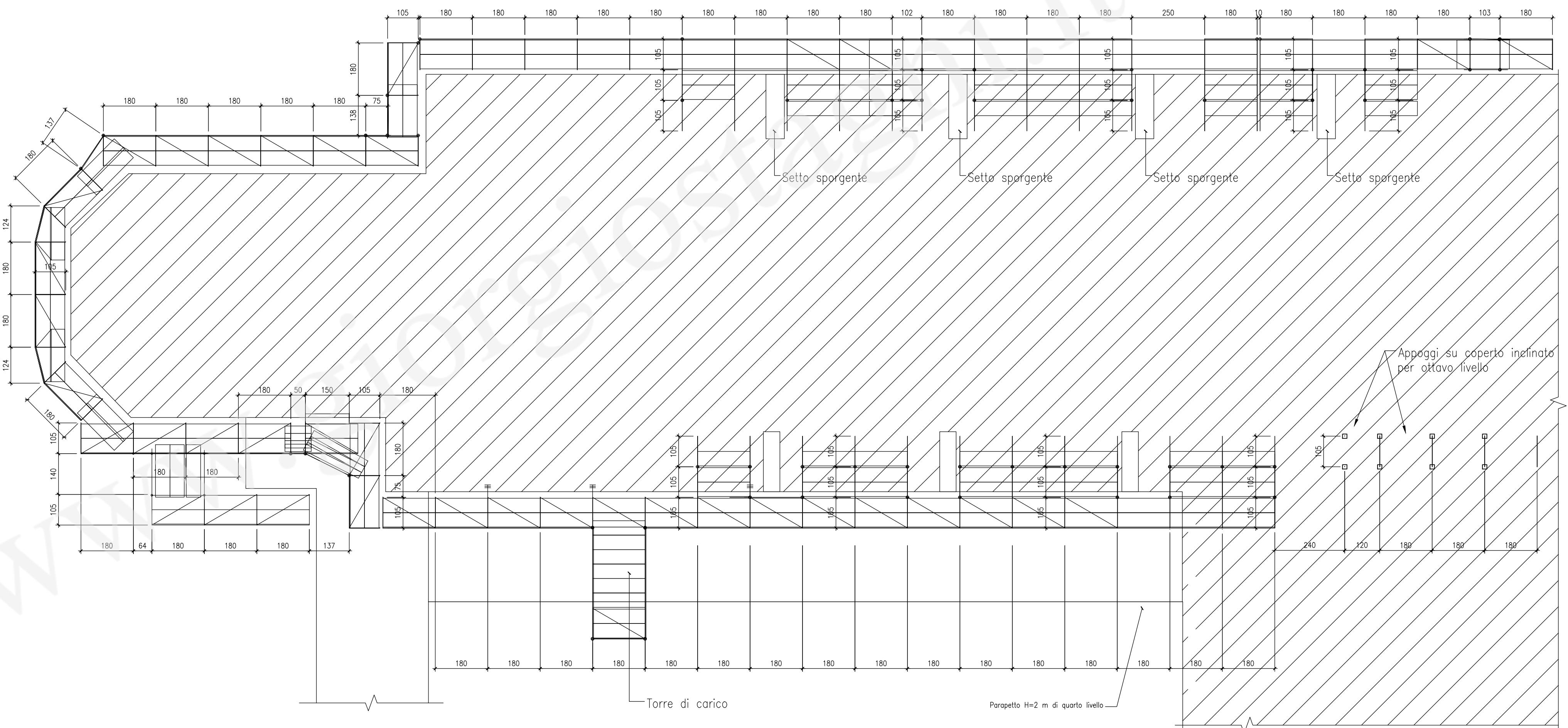
N.B. PONTEGGIO A TELAI PREFABBRICATI TIPO CETA PRE-PONT 1800
